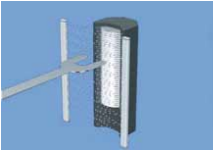
Abbau statischer Elektrizität beim Transport von Halbleiterscheiben
