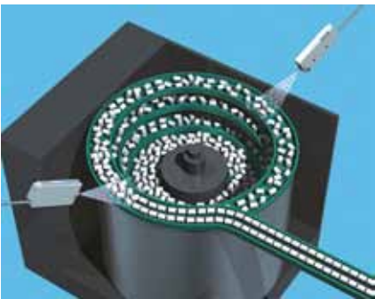
Abbau statischer Elektrizität an Zuführungseinrichtungen
