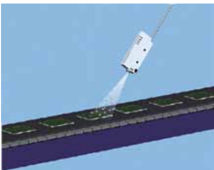
Abbau statischer Elektrizität auf Leiterplatten
