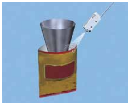
Beseitigung statischer Energie auf Verpackungsfolien
