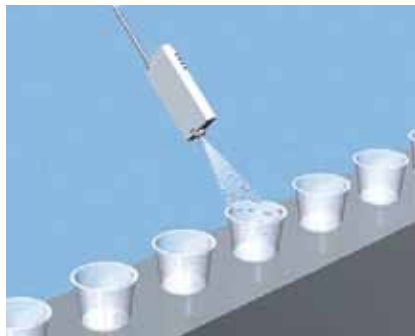
Abbau statischer Elektrizität von Kunststoffassen
