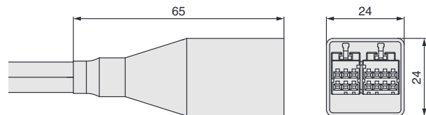
Abmessungen der Steckerabdeckung des batterielosen Absolutwertgebers
